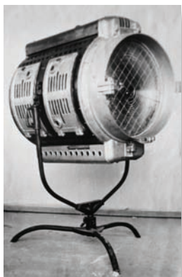
Легендарный ДИГ – дуговой прожектор КПД-50 с линзой диаметром 50 см
